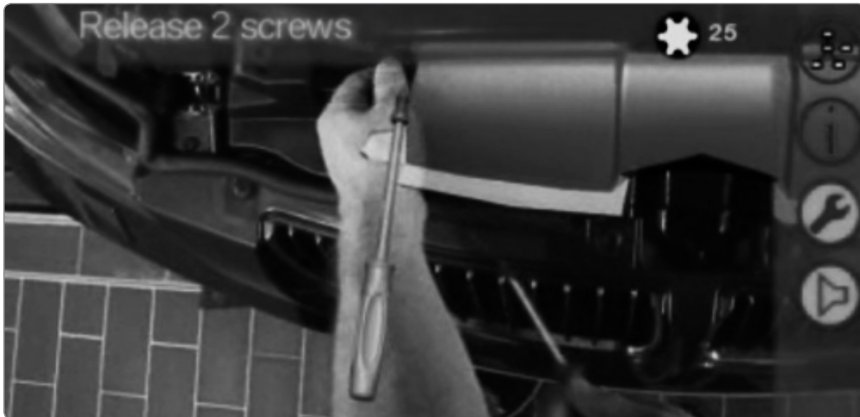
Abbildung 2: Argumented Reality im Kfz-Bereich 3 (Durch eine Brille werden Zusatzinformationen über das reale Bild gelegt.)
